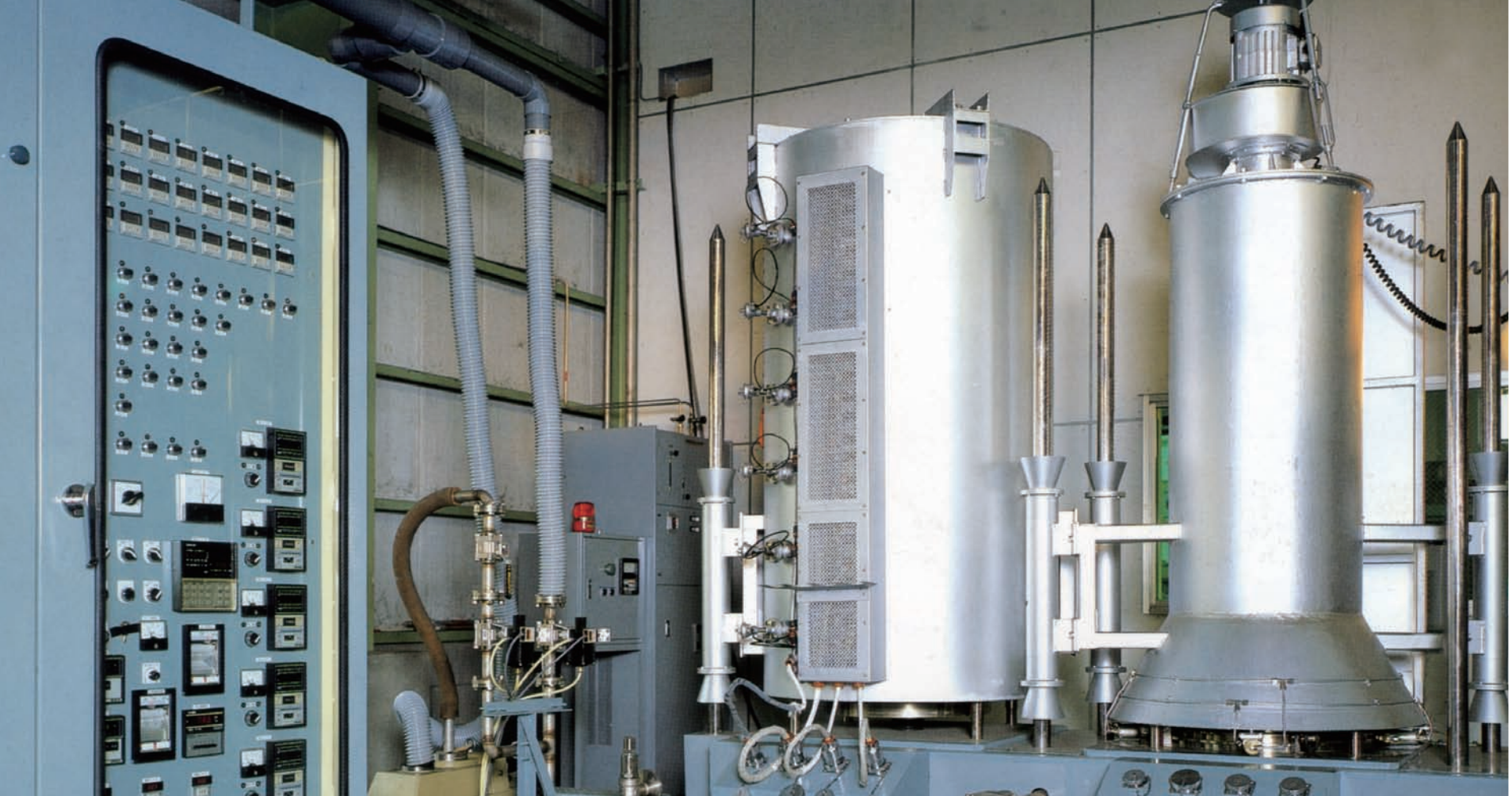
CVD装置 CVDとはChemical Vapor Depositionを省略した言葉で、日本語で化学気相成長と言います。 (chemical: 化学的な vapor: 蒸気・気体物質 deposition: 堆積・沈殿)
